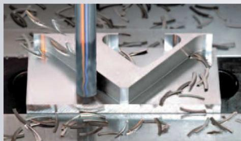
Лучшие показатели на финишной обработке принадлежат пятиперьевой концевой фрезе V-Carb. Уникальная геометрия и угловой радиус позволяют этому инструменту показывать исключительные результаты при чистовой и получистовой обработке. V-Carb может также применяться для фрезерования пазов и черновой контурной обработки.
