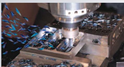
Запатентованная четырехперьевая концевая фреза Z-Carb, имеющая переменные углы спирали, - революционное решение в области фрезерования. Фрезой Z-Carb достигается увеличение производительности до 30 раз в сравнении со стандартной четырехперьевой концевой фрезой при двукратном увеличении снимаемого припуска.
